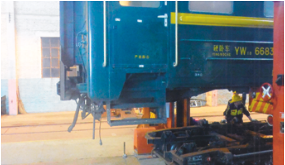
Fahrgestellwechsel: Die Transmongolische Eisenbahn ist Teil der kürzesten Eisenbahnverbindung zwischen Moskau und Peking. | Quelle: © Jeremy Hainsworth, picture alliance/AP Photo.
