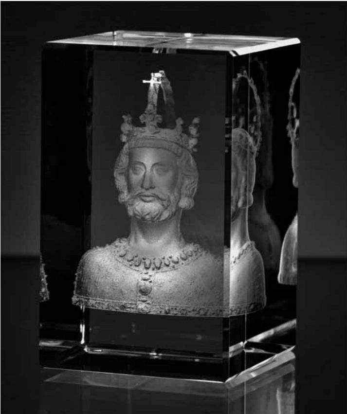
Abb. 7: Mit ps-Laserstrahl erzeugte Glasinnenmarkierung, die einzelnen Bildpunkte entstehen durch Mikrodisruptionen, die nur im Fokus der Laserstrahlung entstehen. Mit Repetitionsraten im Bereich mehrerer 100 kHz kann die Bearbeitungsgeschwindigkeit zu makroskopischen Mustern bereits heute skaliert werden.
