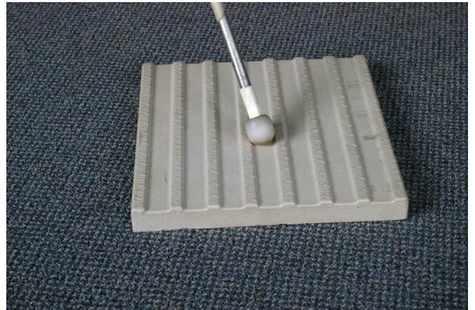
Bild 12: Bodenindikatoren mit 11 mm Abstand der Wellenberge
