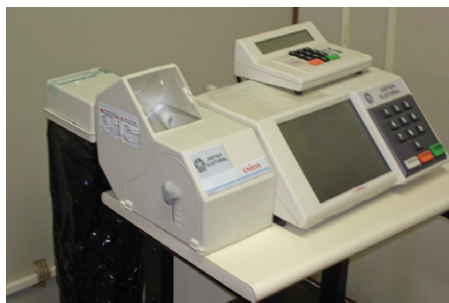
FIGURA 3. Urna modelo UE2002 com suporte ao voto impresso
