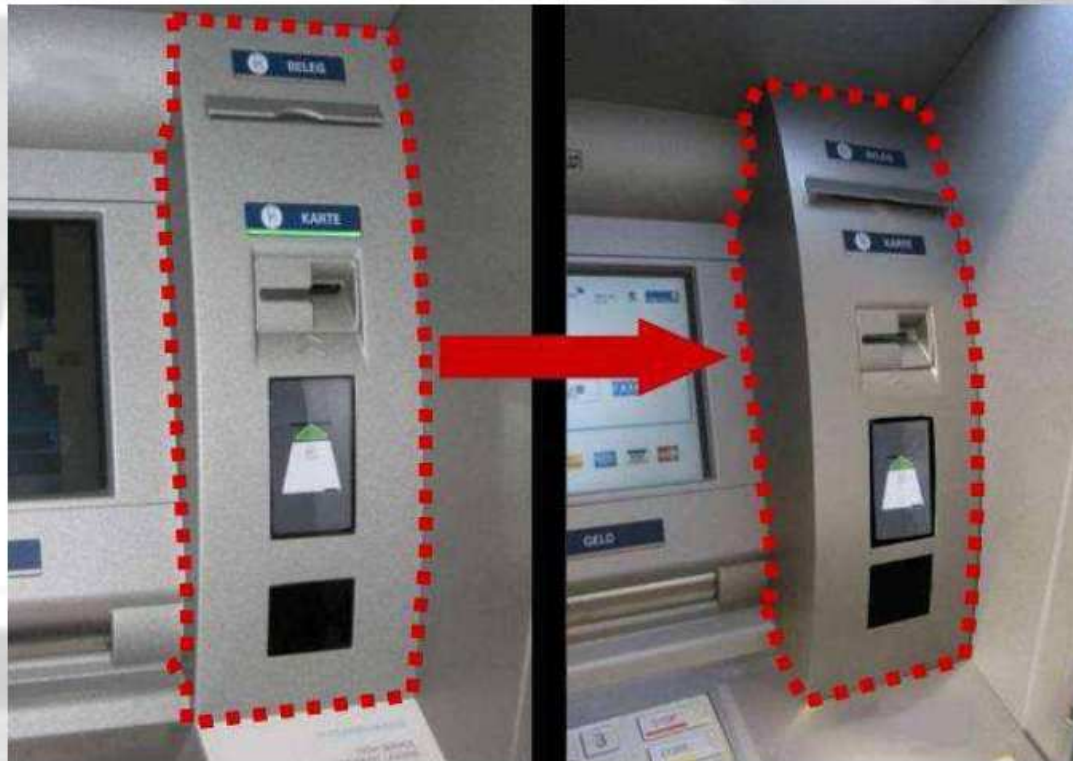
Manipulierter Geldautomat mit aufgesetzter Blende
