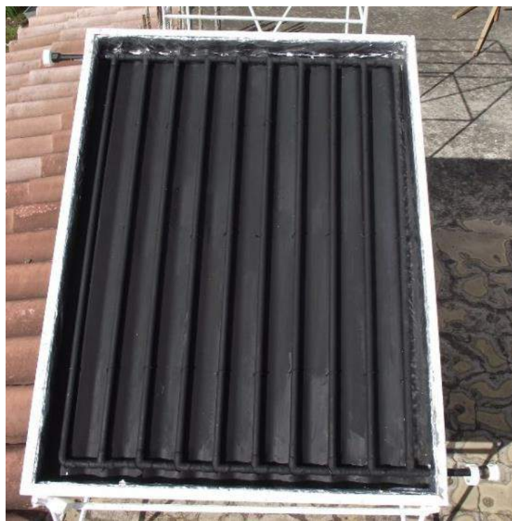
Caja de metal y parrilla de tubos del colector solar
