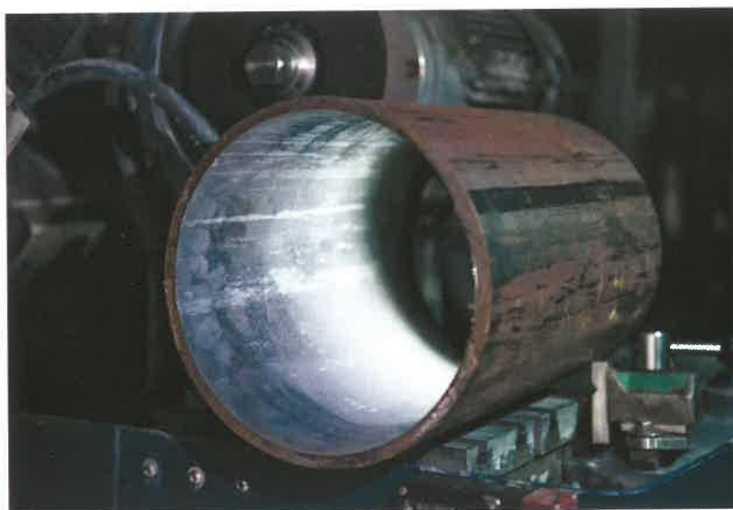
Рис. 33. Первая тестовая труба из разработанного стального проката «Северкор»
