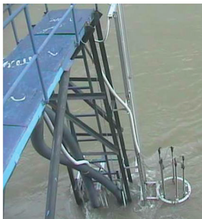
Слика 6.4: Потопени сензори и мерни уреди кои се користат за реално-временско мерење на параметрите за квалитет и квантитет на водата
