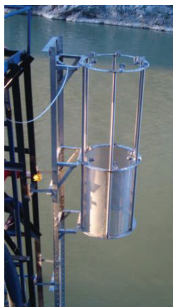
Слика 6.4: Потопени сензори и мерни уреди кои се користат за реално-временско мерење на параметрите за квалитет и квантитет на водата
